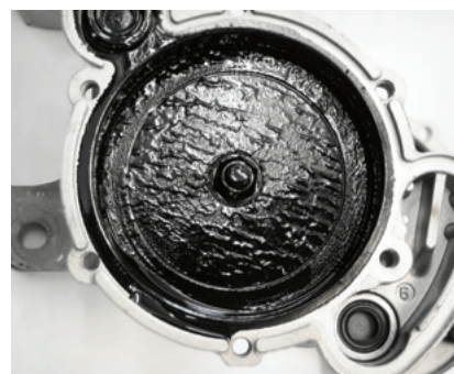
图 3: 大众面包车真空泵内的油泥导致啪嗒作响
